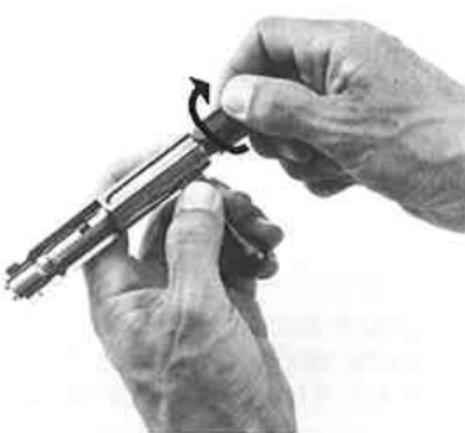
1. La partie antérieure de la culasse peut être démontée sans outils en tournant la partie postérieure dans le sens des aiguilles d'une montre jusqu'à l'obtention de la position selon fig. 1.
