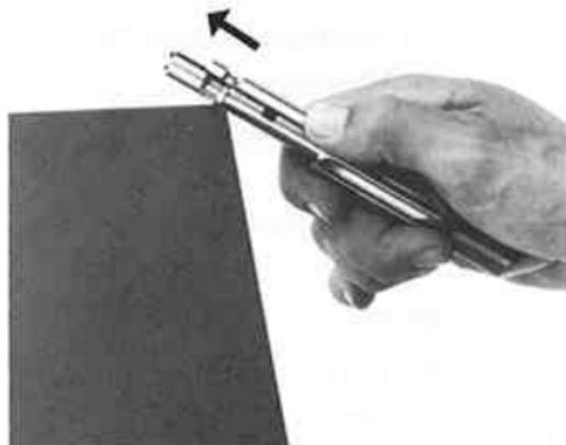
2. Appuyer la culasse sur le bord d'une table par ex. et l'extraire. (fig. 2).
